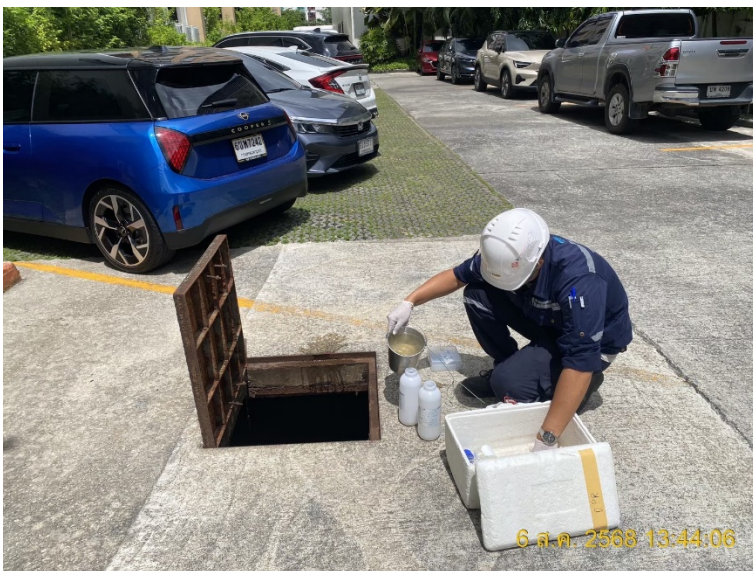
รูปที่ 3.1 การเก็บตัวอย่างน้ำทิ้ง
